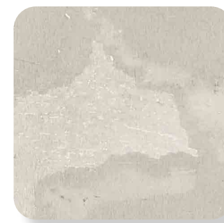
Salzränder (siehe oben) werden durch neutralisieren der Oberflächen vermieden.
