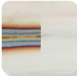
Schweißnaht: Rechte Seite bereits gereinigt.
